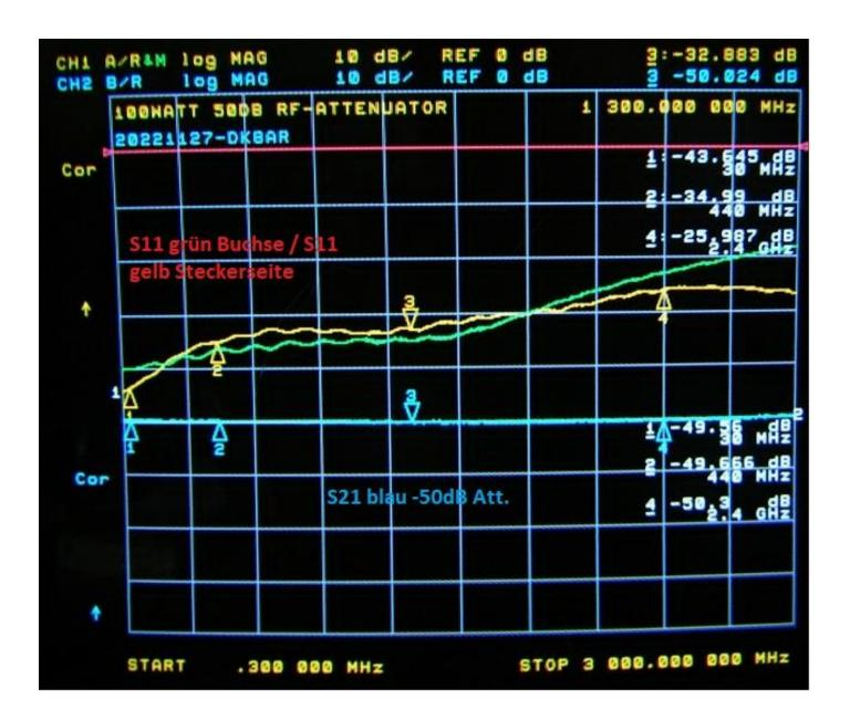
Die grüne Kurve zeigt, dass die angegebene Spezifikation fast erreicht wird 1,288@3GHz (18dB) Dort wird in der Spezifikation <1,2@3GHz angegeben – es gibt keine Einwände vom Verfasser.... Die gelbe Kurve also die Anpassung Richtung Messgerät ist sehr gut 26dB@2,4GHz (SWR 1,1) Mit 90€ hat man wirklich ein gutes Messzubehör was nirgends fehlen sollte!
