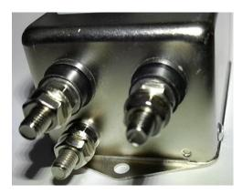
**Die M6 Anschlüsse an dem EMI Filter zur Installation:** Ringkabelschuhe verwenden, Ringkabelschuhe für Querschnitte 16-25mm² - Loch-Ø: M6
