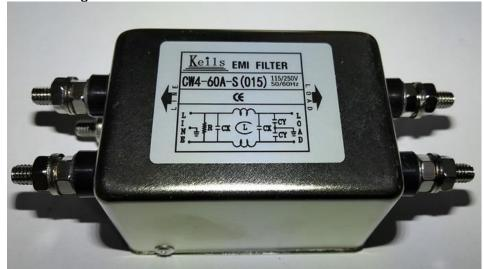
Das EMI Filter ist natürlich größer als die davor gemessenen 20 oder 30 Ampère Typen. Die Schraubanschlüsse sind M6 mit den dazugehörigen Muttern und U-Scheiben. Auch ist die Schaltung anders wie man auf dem Aufdruck erkennen kann. Dort finden wir zwei X Kondensatoren und natürlich die Y Kondensatoren-Schaltung dazu noch ein Entladewiderstand.
