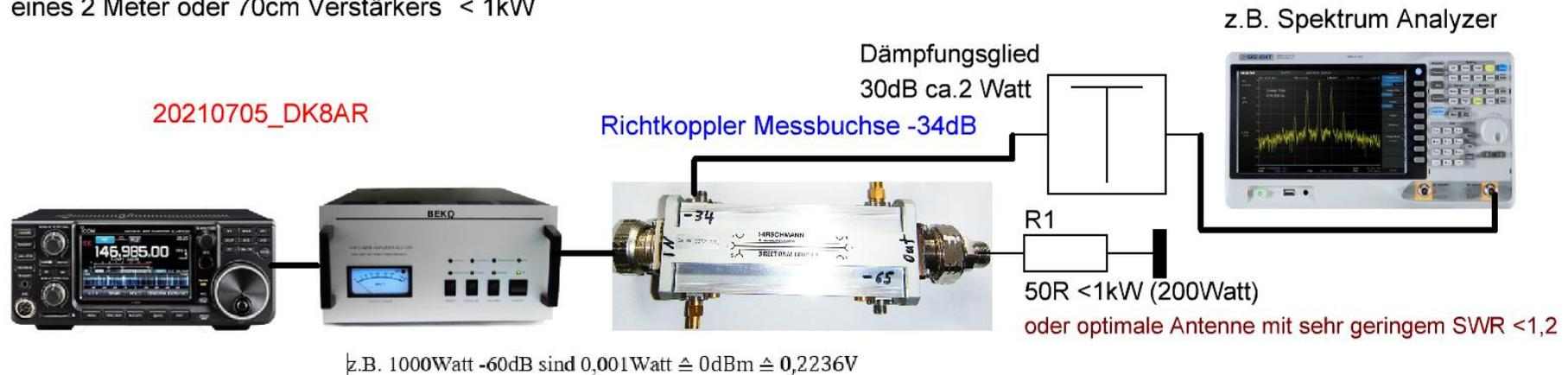
Mit diesem Aufbau kann gefahrlos an der Ausgangsbuchse ein Analyzer zur Signalanalyse, ein Powermeter Boonton 4200 oder ein Millivoltmeter von R&S URV 4 zwecks Messung der Ausgangsspannung oder Leistung in dBm eingesetzt werden!
